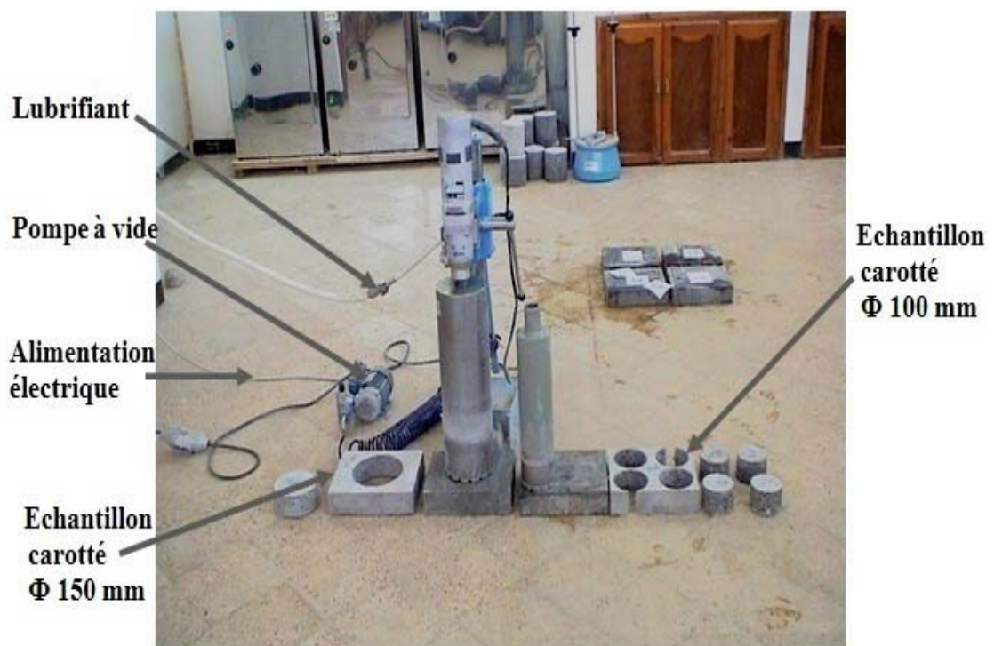
Figure 2.19 : Carottage des échantillons destinés aux essais de perméabilités au gaz et aux ions chlorures
