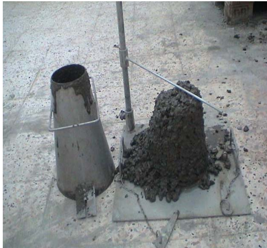
Figure 2.12 : Essai d'affaissement (cône d'Abrams)
