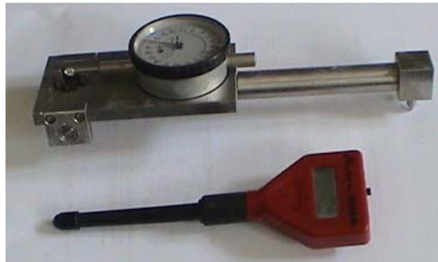
Figure 2.26 : Appareil pour mesurer d'expansion des mortiers
