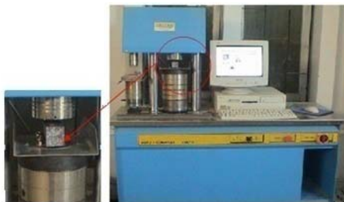
Figure 2.27: Dispositif de l'essai de compression
