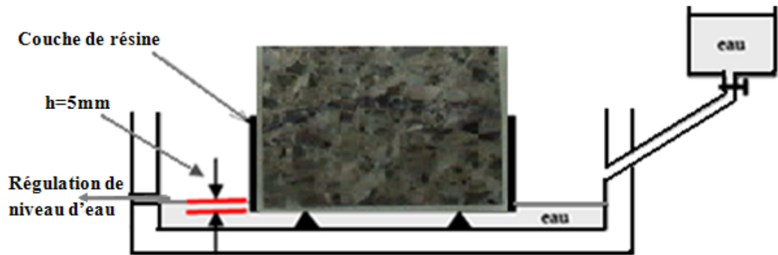
Figure 2.14 : Dispositif expérimental de mesure d'absorption d'eau par capillarité
