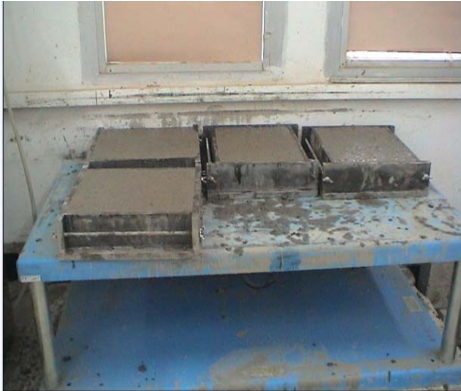
Figure 2.9 : Compactage du béton à l'aide d'une table vibrante
