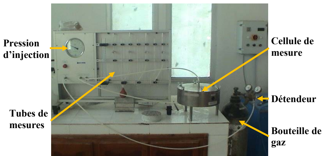
Figure 2.21: Perméamètre au gaz de CEMBUREAU
