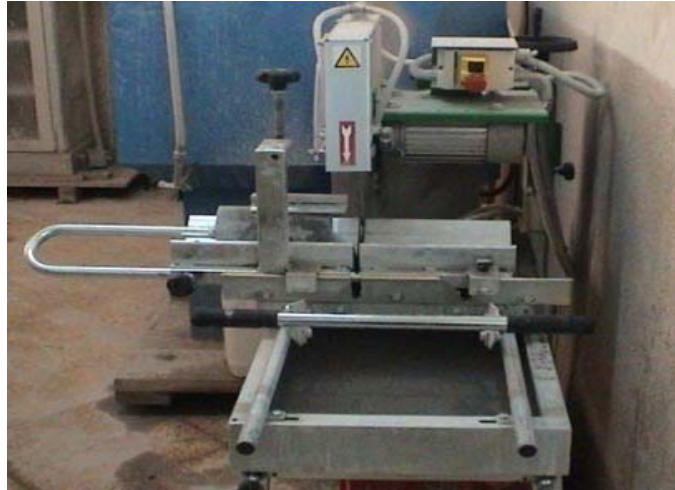
Figure 2.20 : Rectification des éprouvettes
