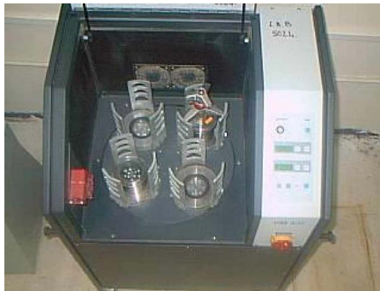
Figure 1.10 : Broyeur planétaire, de marque commerciale Retsch PM 400 (modèle Pulvérisette 7), utilisé pour la mécanosynthèse des alliages Fe-Co.
