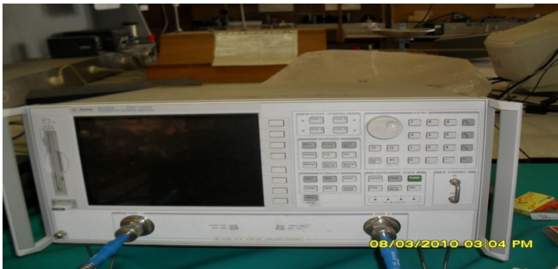
Figure 4.5 : Analyseur de réseaux (Agilent 8719ES)
