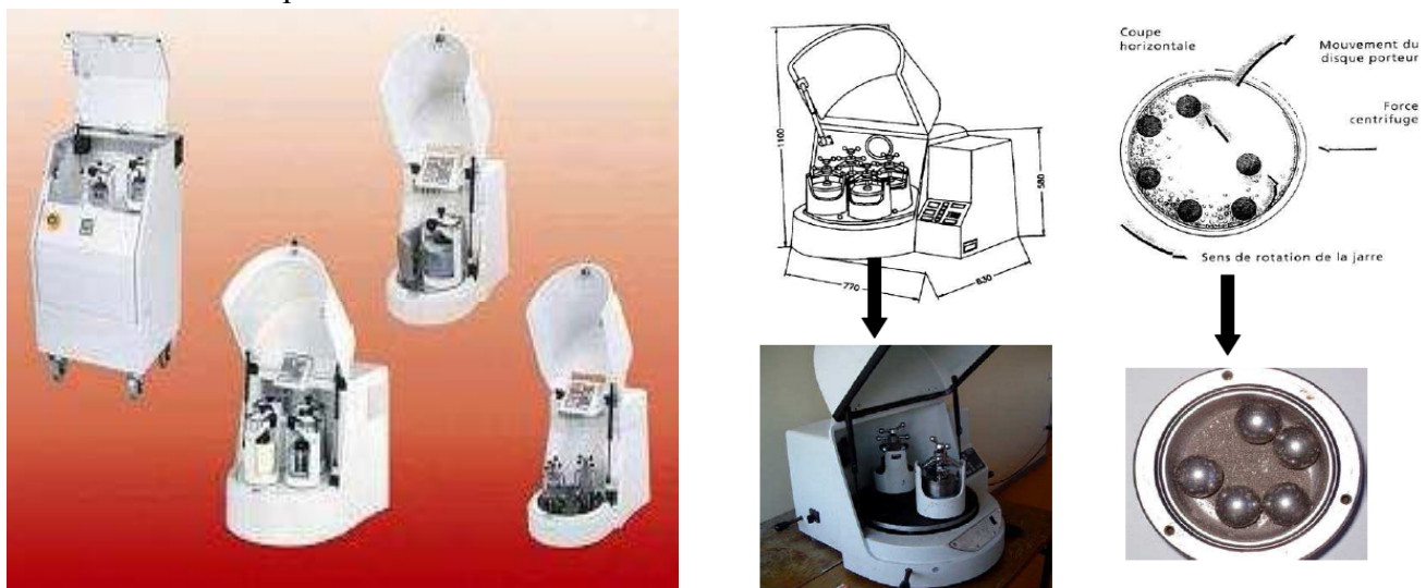
Figure 1.6 : Schématisation d'un broyeur planétaire et de l'action des billes pendant le processus.
