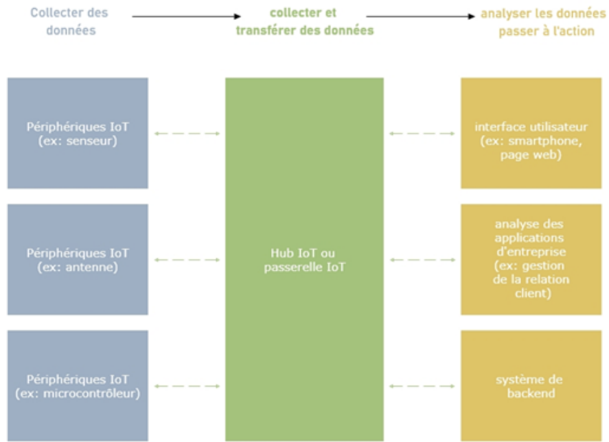
Figure 1 Schéma montre le fonctionnement et l'interaction d'un système IoT [1]
