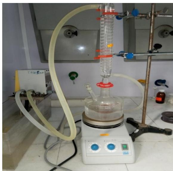
**Figure II.4 : le montage à reflux**
