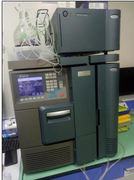
Figure 23 Chaîne HPLC Waters e2695 détecteur UV-Visible 2489
