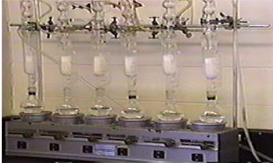
Figure 3.3. Montage du Soxhlet
