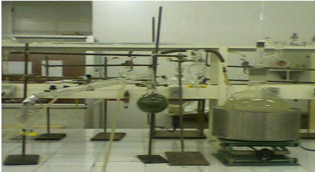
Figure 3.2. Montage de l'entraînement à la vapeur d'eau.
