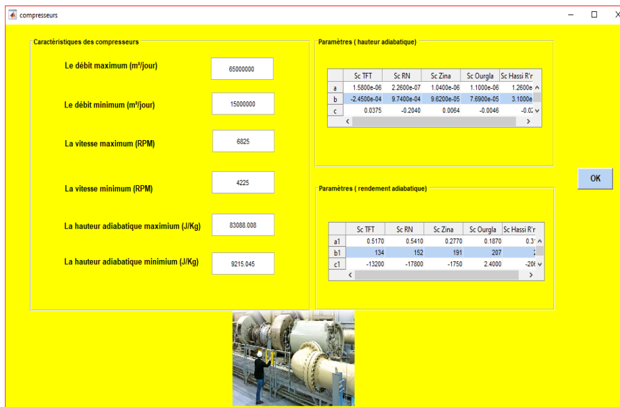
FIGURE 5.8 – Interface des caractéristiques des compresseurs
