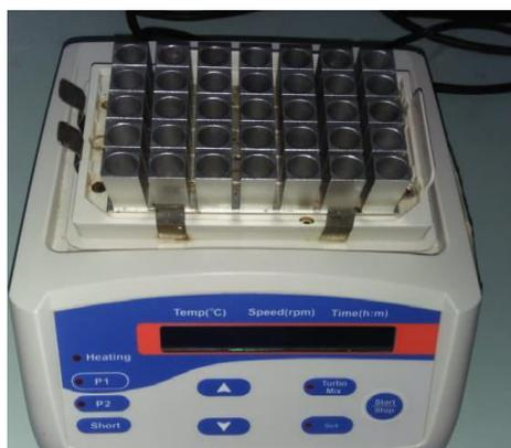
Agitateur avec plaque centrifugeuse chauffante
