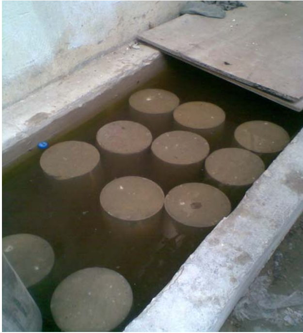
Eprouvettes cylindriques avant l'écrasement
