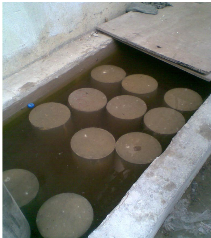
Figure 4.2 : Conservation des éprouvettes dans un bassin (sous l'eau )
