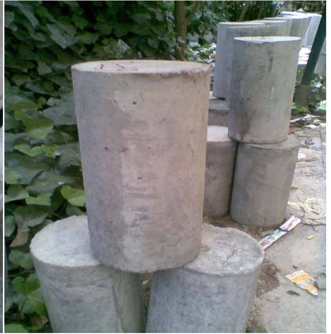
Eprouvettes cylindriques avant l'écrasement
