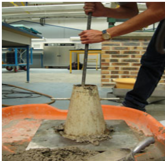
Figure 2.1 LE CÔNE D'ABRAMS
