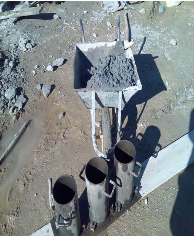
Remplissage des moules cylindrique
