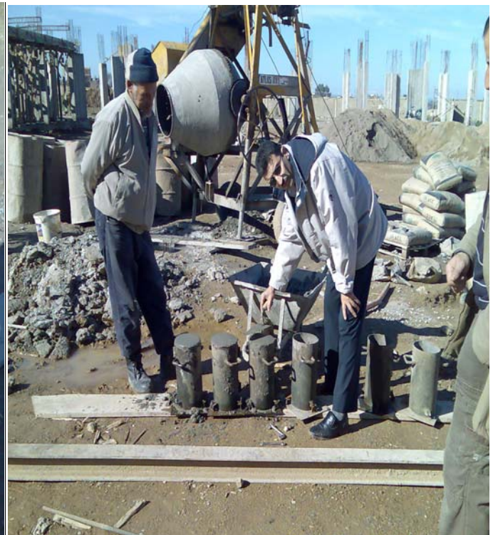
Remplissage des moules cylindrique
