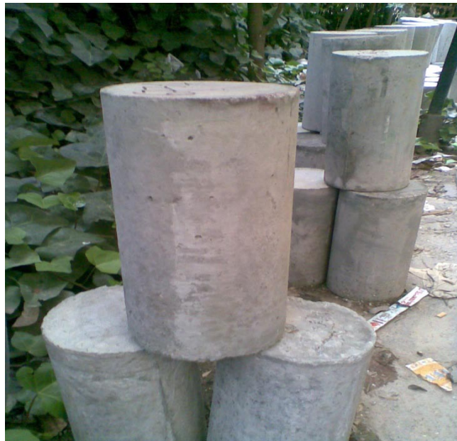
Figure 4.3 Epreuve en béton cylindrique avant l'essai d'écrasement
