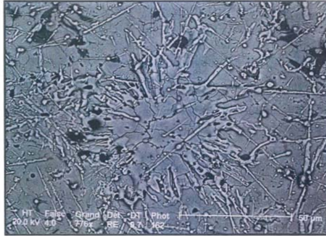
Figure 1-16 : Micrographies de lamelles de zircone obtenues par impact D'une gouttelette liquide sur substrat lisse, T < T_t [38]
