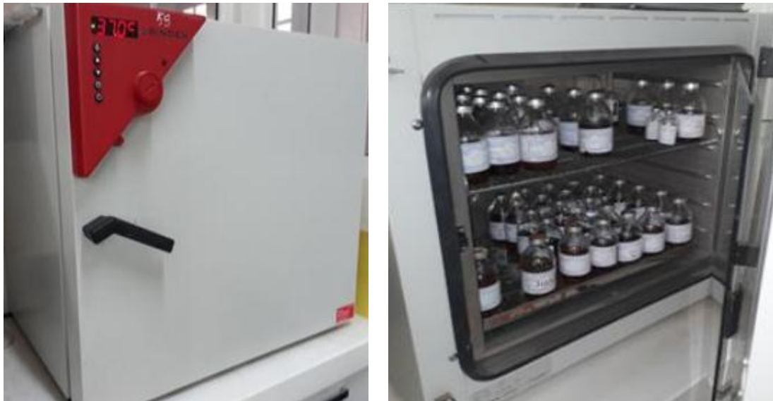
Figure 2. Etuve d'incubation des flacons d'hémoculture (37°C)
