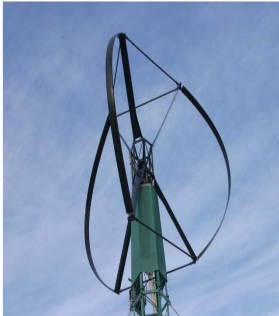
Figure I-3 : Éolienne à axe vertical de type Darrieus [1]
