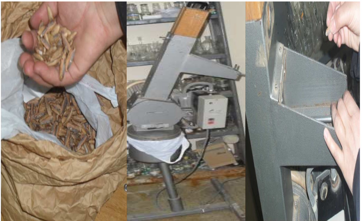
Figure 4.2 : Broyeur utilisé pour le broyage des noyaux de dattes (original)
