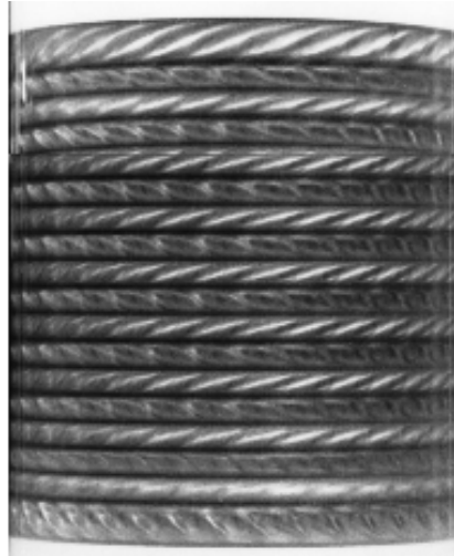
Figure 2.3 : Instabilité primaire (en rouleaux) dans un système de Couette-Taylor [35].
