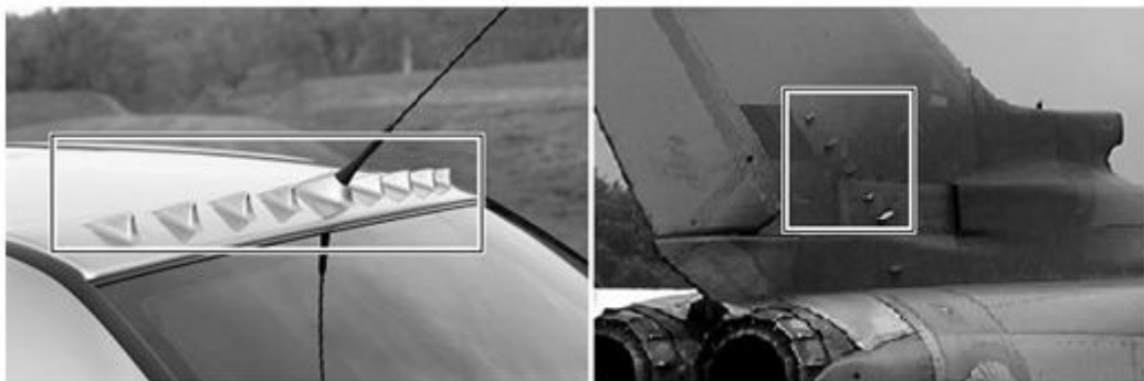
Figure 2.5 : Générateurs de vortex à l'arrière d'une voiture (à gauche) et sur la gouverne d'un avion (à droite).
