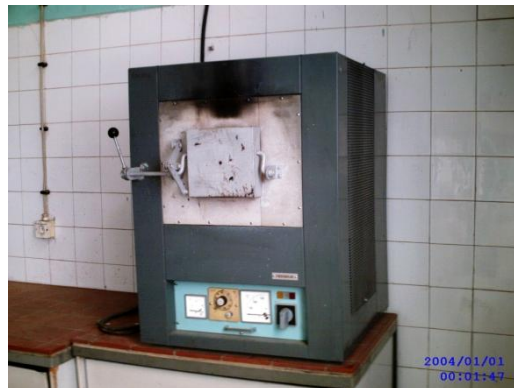
Figure 11 : four de traitements thermiques.
