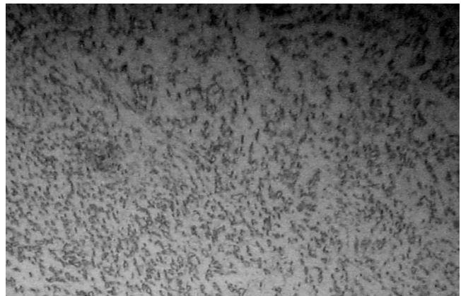
Fig.13 Structure de Widmanstätten à l'état brut de coulée Pour la Nuance à (0.15% Nb) x 500
