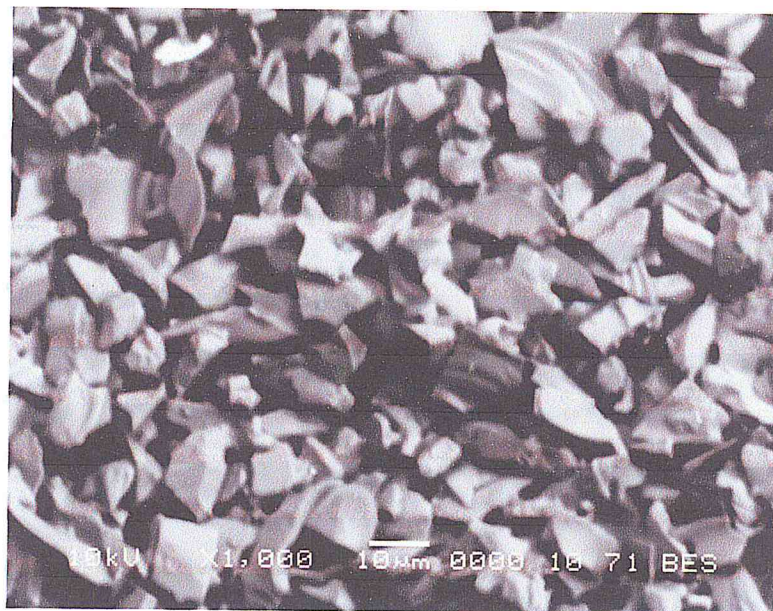
Figure III-4: Morphologie de la poudre de 6H-SiC
