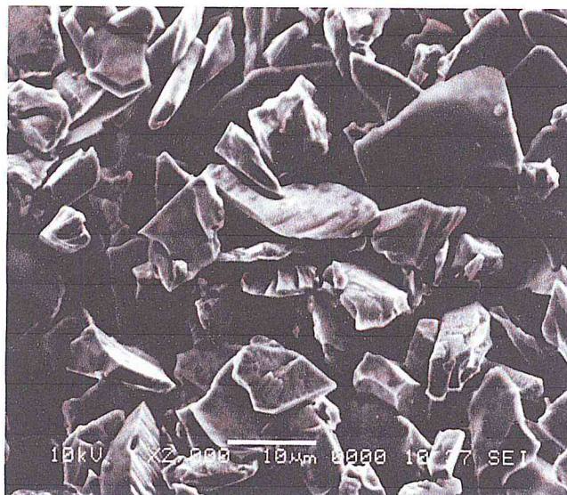
Figure III-11: image observée au MEB d'une micropoudre de SiC après porosification par attaque chimique dans une solution HF/Na 2 Cr 2 O 7 (1/1) sous irradiation UV de \lambda=365 nm, t=40 min, T=80^{\circ}\text{C} (semi-rinçage à l'eau régale), (photo MEB /CDTA)
