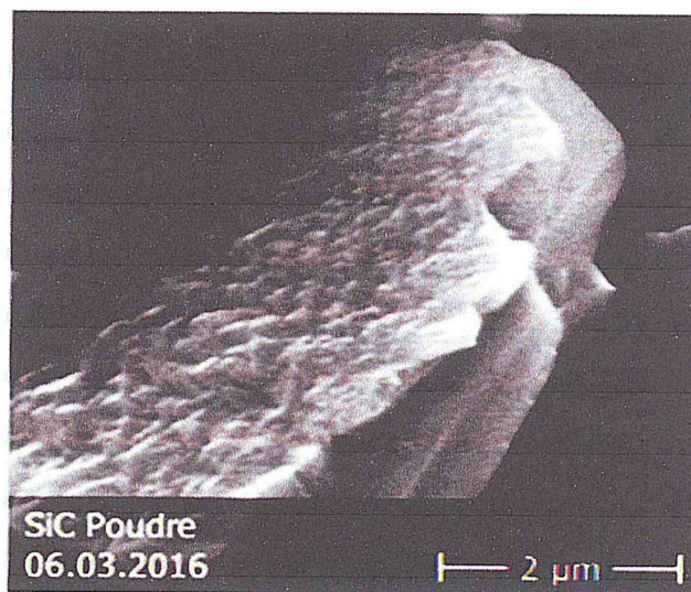
Figure III-13: Image observée au MEB d'une surface d'une microparticule de SiC obtenue après porosification par attaque chimique dans une solution HF/K 2 S 2 O 8 (1/1), sous irradiation UV de longueur d'onde λ=365nm, t=40 min, T= 80°C
