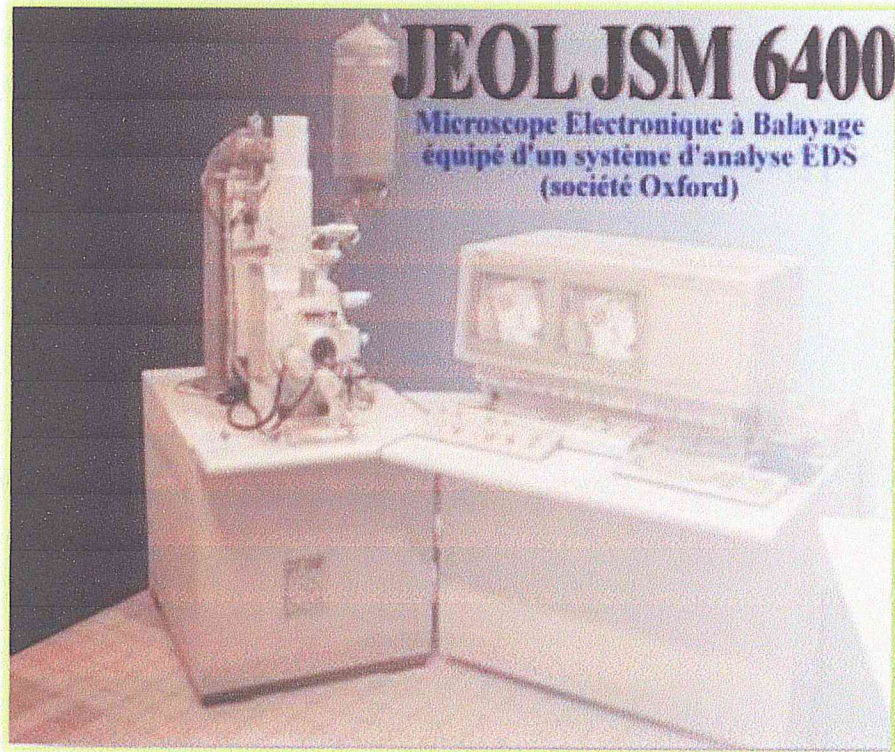
Figure II-12: Microscope électronique à balayage JEOL, modèle JSM 6400 équipé d'un système d'analyse EDS.
