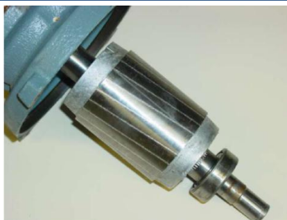
Figure 1.2: Rotor à cage d'écurieil d'une machine asynchrone
