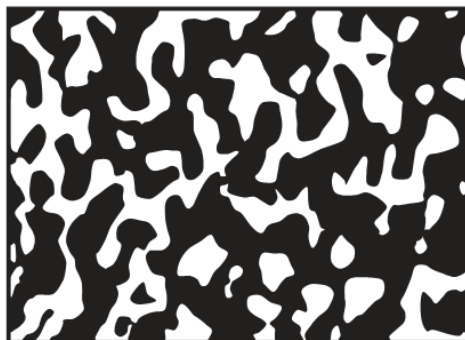
Figure 2.19: Matériau FGM à deux phases avec microstructure squelettique
