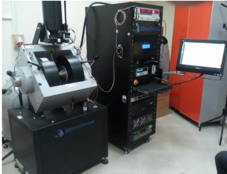
Figure (2.15) : photographies de magnétomètre d'échantillon vibrant (VSM)
