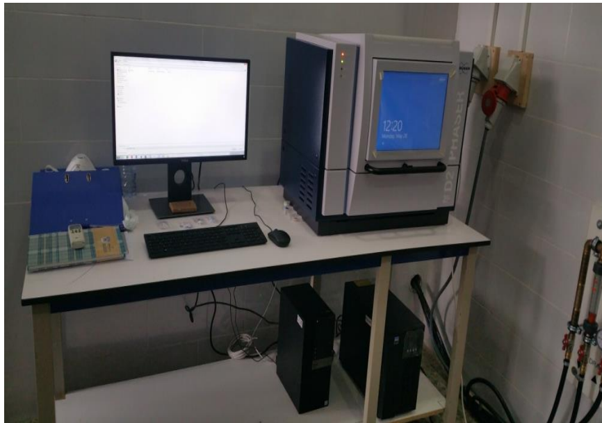
Figure (2.13) : Photographie de l'appareil utilisé pour réaliser DRX.
