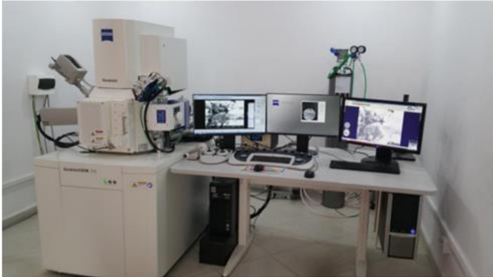
Figure (2.10) : l'appareil MEB équipé d'un détecteur EDS
