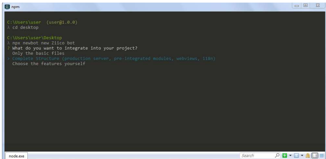
Figure V.2 : Création d'un nouveau projet sur Newbotframework
