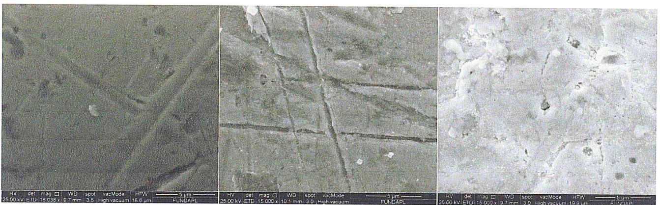
(a) Avant chauffage (b) Après chauffage à 200 °C (c) Après chauffage à 400 °C
