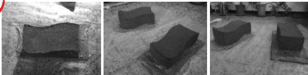
Figure 106, 107 et 108 : La brique innovante finie après démoulage.
