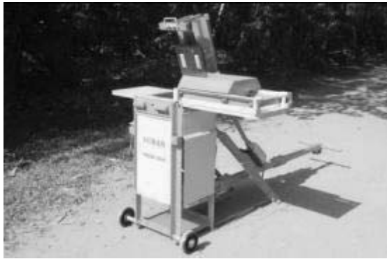
Figure 15 : Auram press 3000. Presse manuelle d'Auroville.
