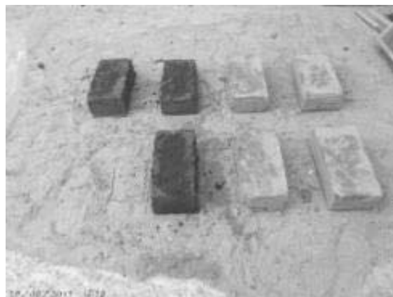
Figure 74 : Briques après une semaine de séchage. © Auteur.
