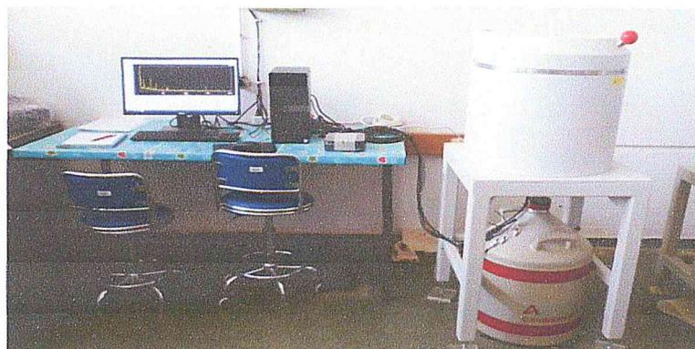
**Figure IV.3 :** La chaîne de spectrométrie gamma.
