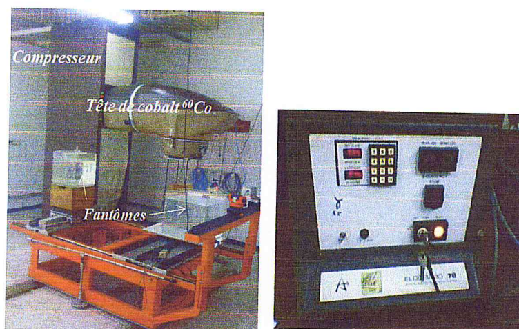
Figure II.3. Unité de cobalt et sa console de command ELDORADO 78 (LSED) CRNA
