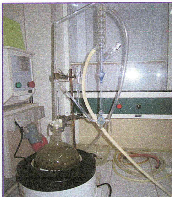
Figure 20 : Obtention de l'HE par hydrodistillation "montage Clevenger".
