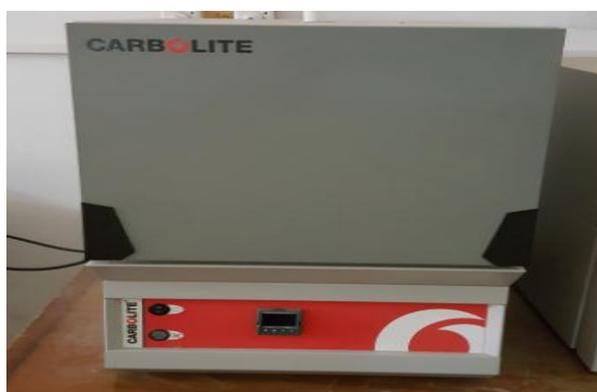
Figure 2-8 : Four à moufle de type CARBOLITE.
