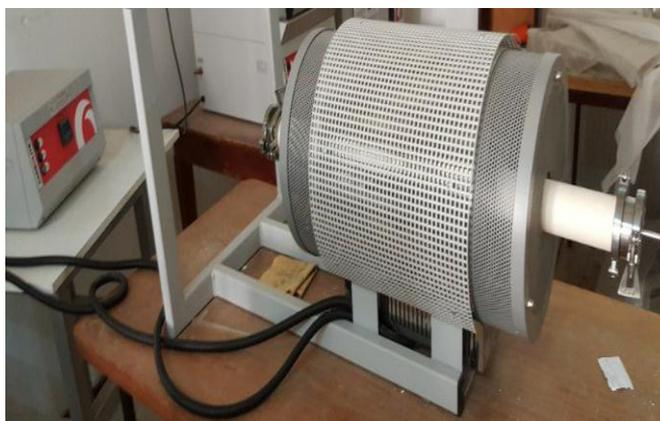
Figure 2-7 : Four tubulaire de marque CARBOLITE.
