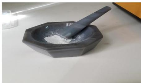
Figure 2-5: Mortier et pilon en agate.
