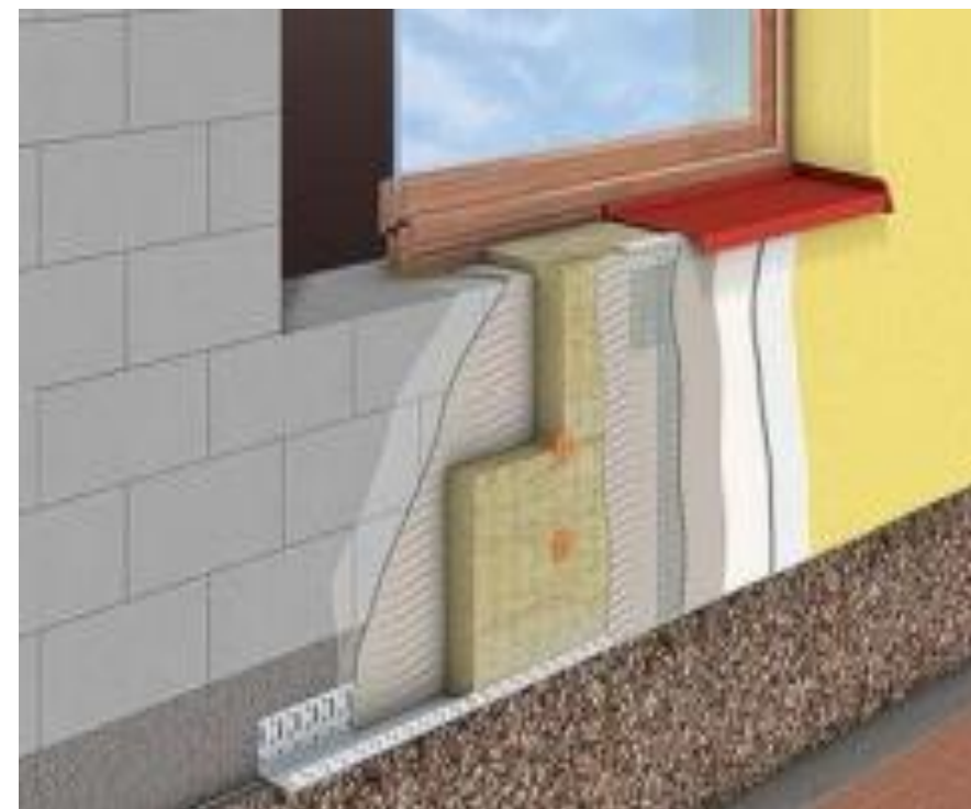
Figure : Isolation des murs par l'extérieure.
