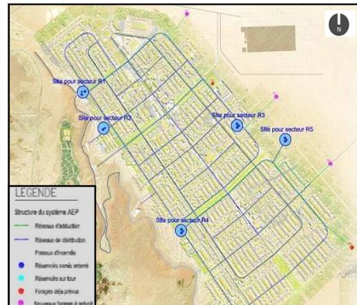
Figure 25 : Réseau d'alimentation en eau potable. Source : Egis 2012.
