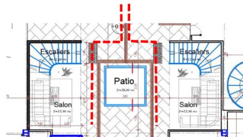
**Fig 5.85 : Bande de guidage**
