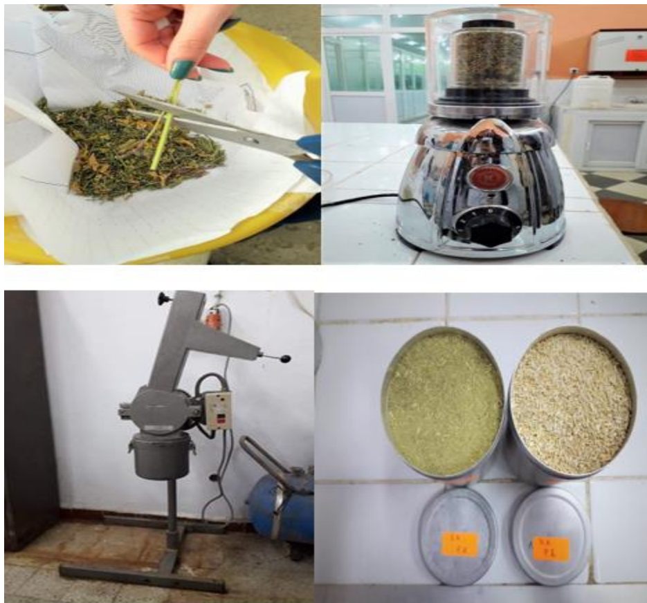
Figure 8 : Broyage des différents organes (tiges, feuilles et racines) à l'aide d'un broyeur électrique (Source personnelle, 2020).
