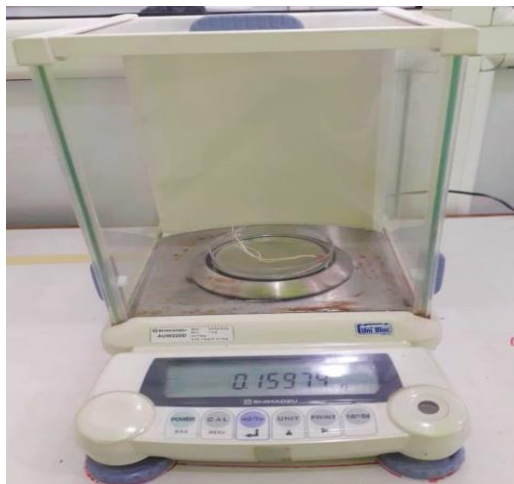
Figure 13 : Mesure de la biomasse fraîche à l'aide d'une balance de précision (Source personnelle, 2020).
