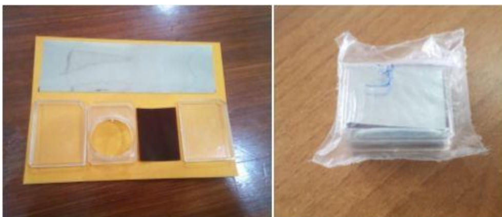
Figure 14. Dosimètre du radon à base de DSTN type LR-115
