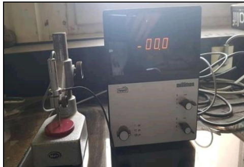
Figure 18. Comparateur d'épaisseur résiduelle type Millitron
