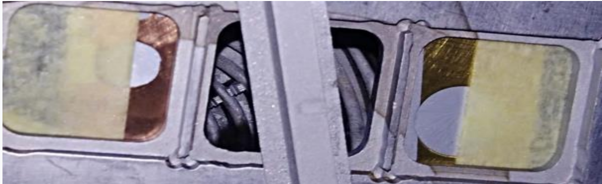
Figure 5: Une photo du support Al équipé pour recevoir l'évaporation LiF sur seulement une partie de la surface
