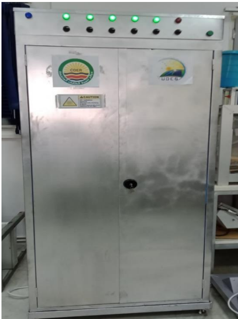
Figure II.7 : Armoire de stérilisation UVC
