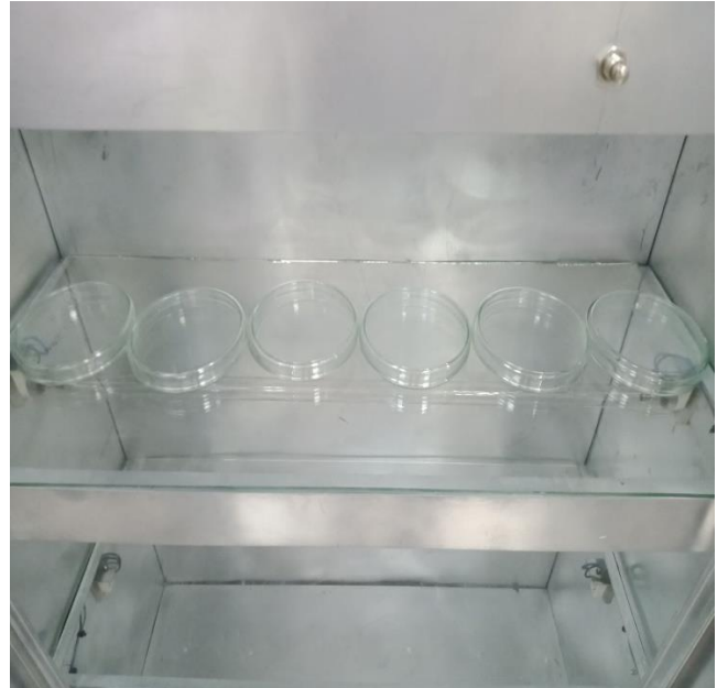
Figure II.7 : Armoire de stérilisation UVC
