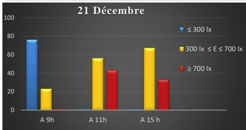
Figure 50 : histogramme du confort au niveau des salles de classe (combinaison d'indicateurs) Source : auteur
