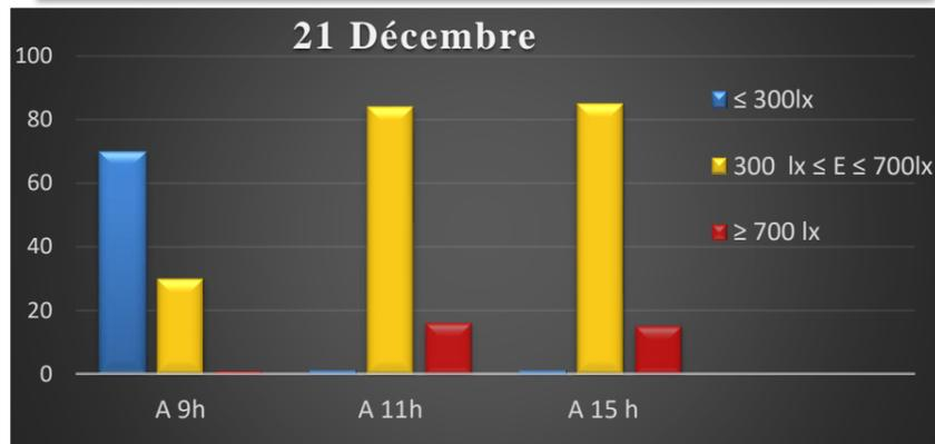
Figure 59 : histogramme du confort au niveau des salles de classe (simulation avec double vitrage) Source : auteur
