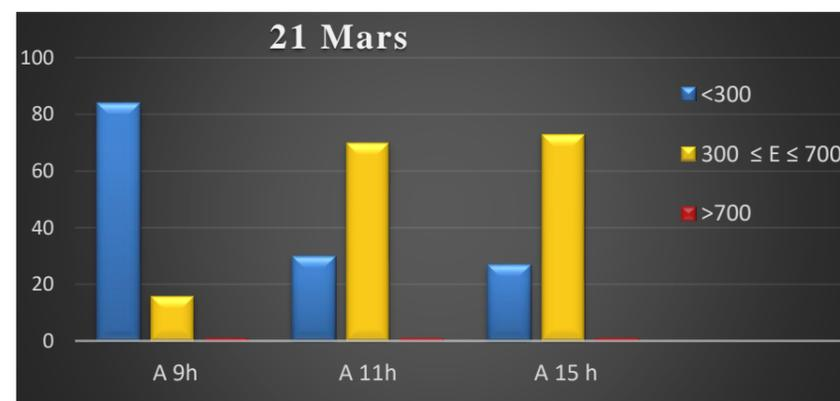
Figure 24 : histogramme du confort au niveau des salles de classe (appui de fenêtre 0.2m)
