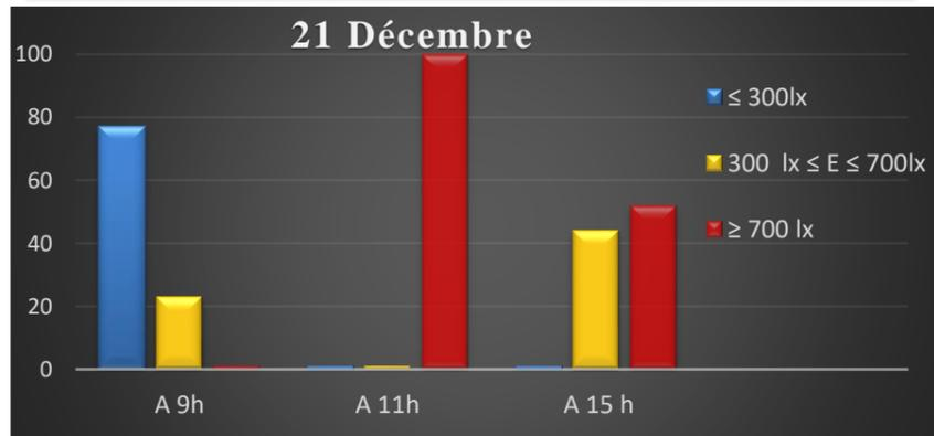
Figure 34 : histogramme du confort au niveau des salles de classe (jambage de fenêtre 40 cm) Source : auteur
