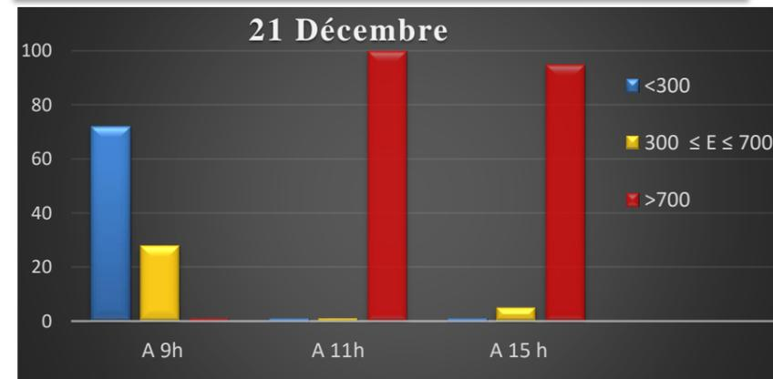
Figure 21 : histogramme du confort au niveau des salles de classe (appui de fenêtre 0.5m)
