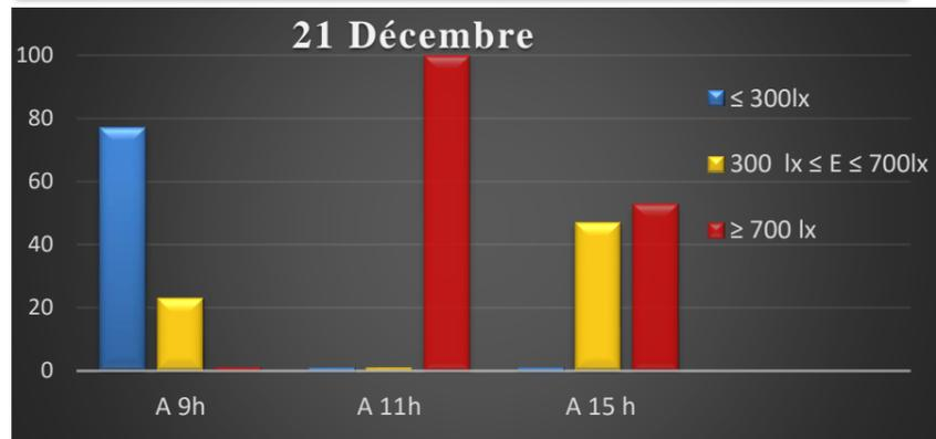
Figure 37 : histogramme du confort au niveau des salles de classe (jambage de fenêtre 30 cm) Source : auteur
