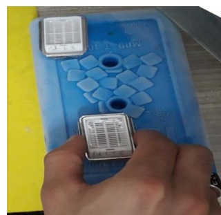
Fig. 24 : Mise en place de l'ensemble moule-cassette sur un bain de glace
