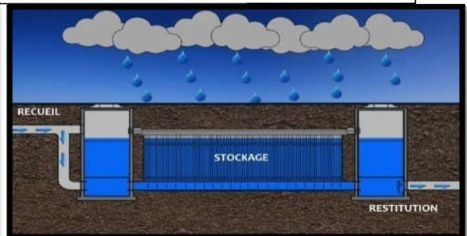
Figure 142 : Technique de stockage de l'eau pluviale ; source : autonomie.eaudepluie.free.fr
