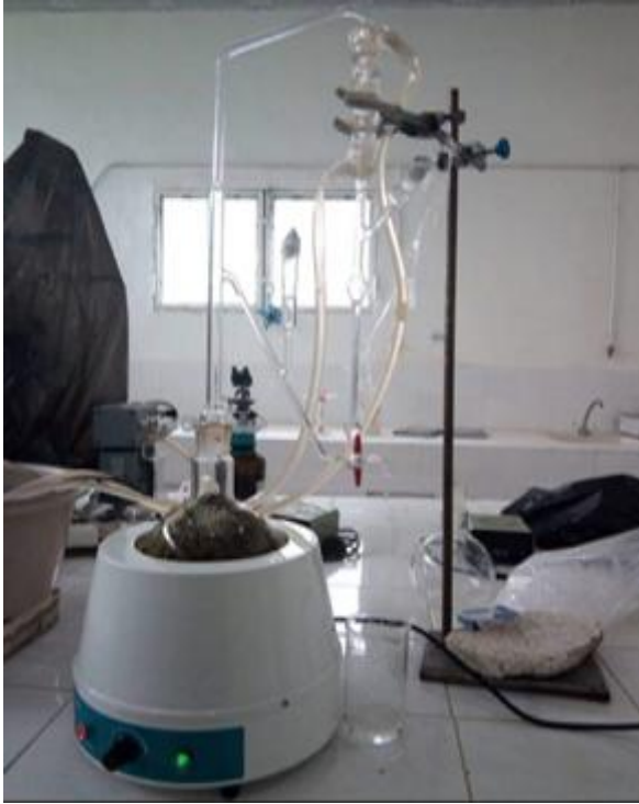
Figure 12 : Dispositif de Clevenger pour l'hydro distillation
