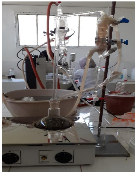
Figure 7 : Montage de l'hydrodistillation employé pour l'extraction de l'huile.
