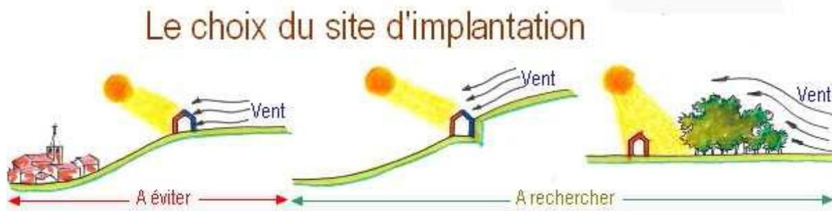
Figure II 23 : Le choix optimal d'implantation du bâtiment
