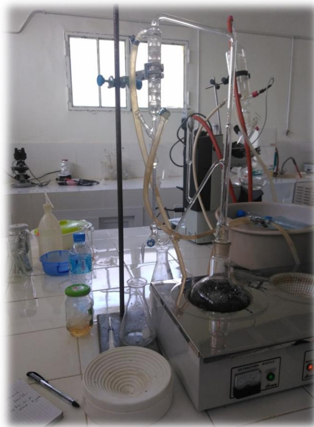
Figure 20 : Hydrodistillation des huiles essentielles de Salvia officinalis L «clévenger».
