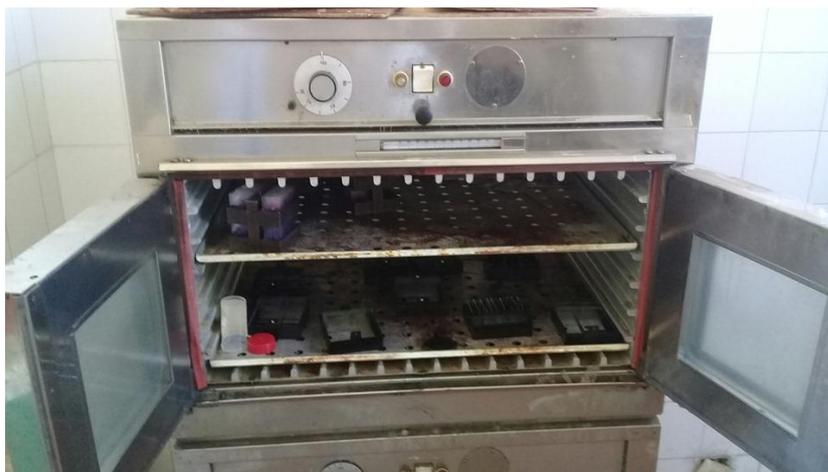
**Figure 15:** séchage des lames dans une étuve à 100 °C (**originale**).
