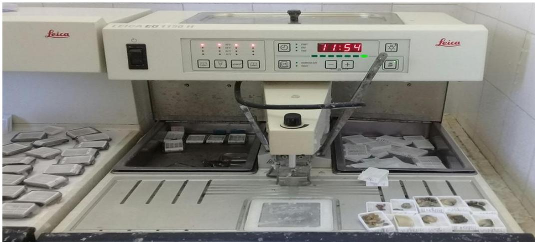
**Figure 12 :** Automate d'inclusion Leica (Originale).
