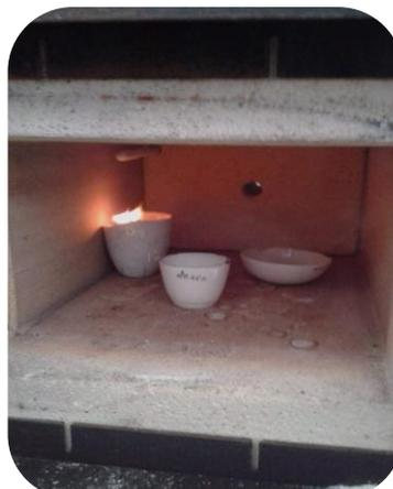
figure 5 : incinération de la farine dans le four à moufle
