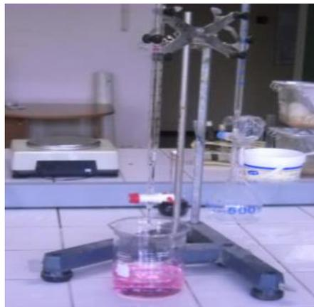
**Figure 30.**dispositif de titrage (Nani, 2011).
