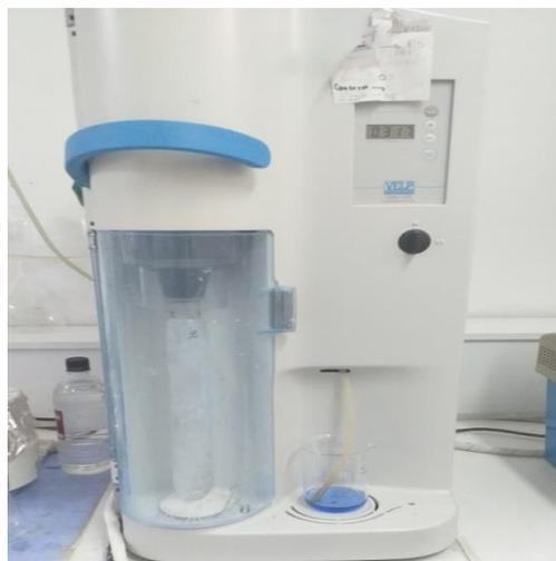
**Figure 29.**Distillateur de Kjeldahl.
