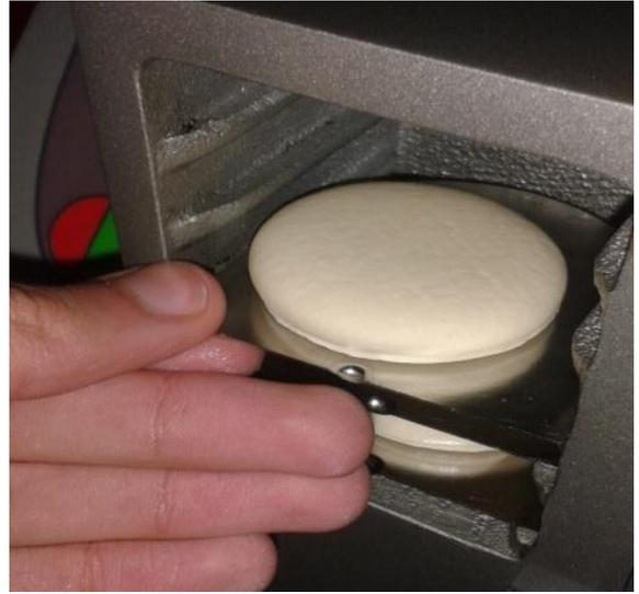
**Le placement des plaque dans l'enceinte isotherme 25°C.**
