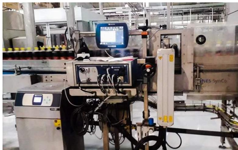
**Figure n°14.** Illustration d'un dateur.
