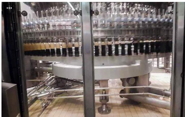
**Figure n°11**: illustration d'une Remplieuse.
