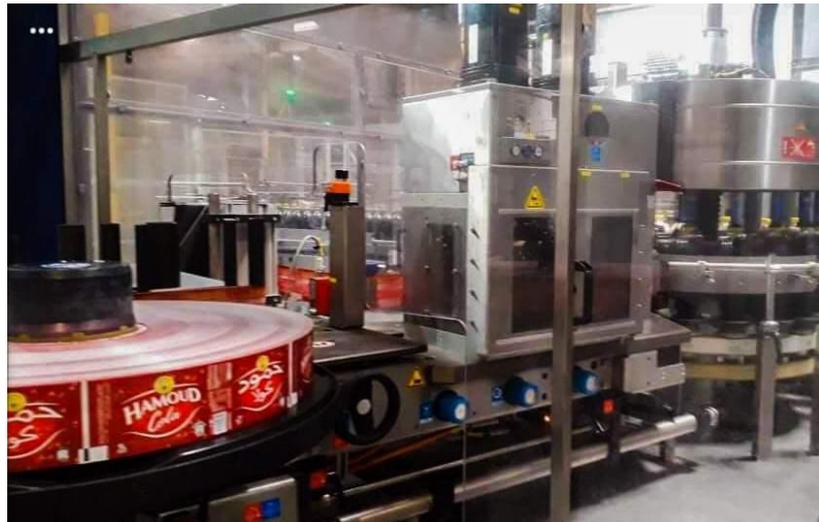
**Figure n°13.** Illustration d'une étiqueteuse.
