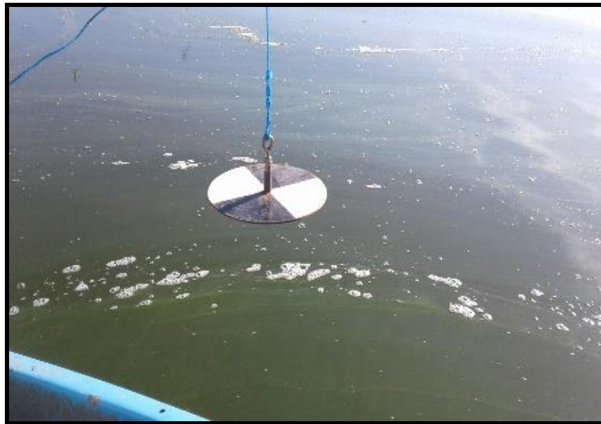
Figure 14. Disque de Secchi.
