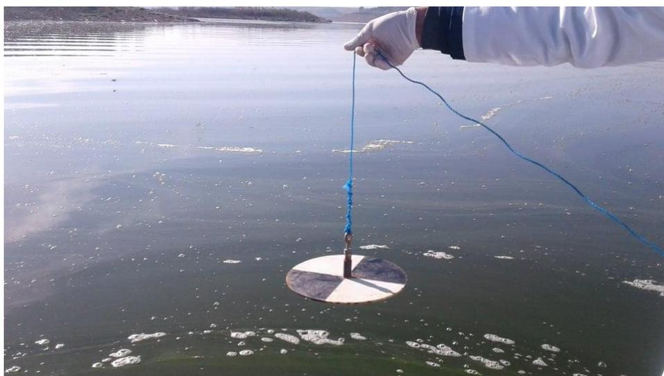
**Fig 03:** Mesure de la turbidité avec un disque de Secchi (photo originale).
