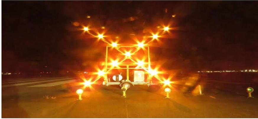
**Figure IV.B.1: Disposition de la croix lumineuse sur une piste.**
