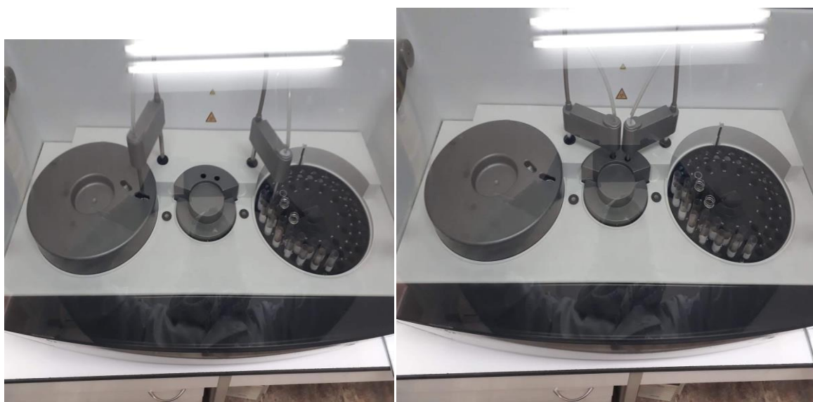
Figure23 : Les aiguilles qui assurent le pipetage en \mu\text{l} .
