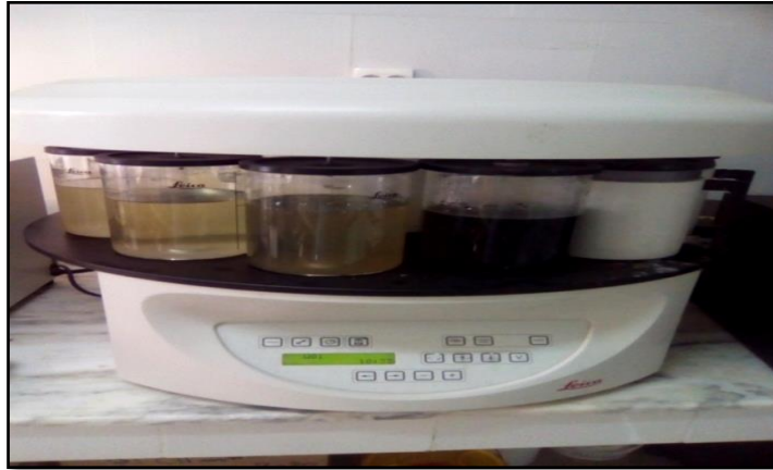
Figure 10 : Automate de traitement des tissus du type Leica (photo originale).
