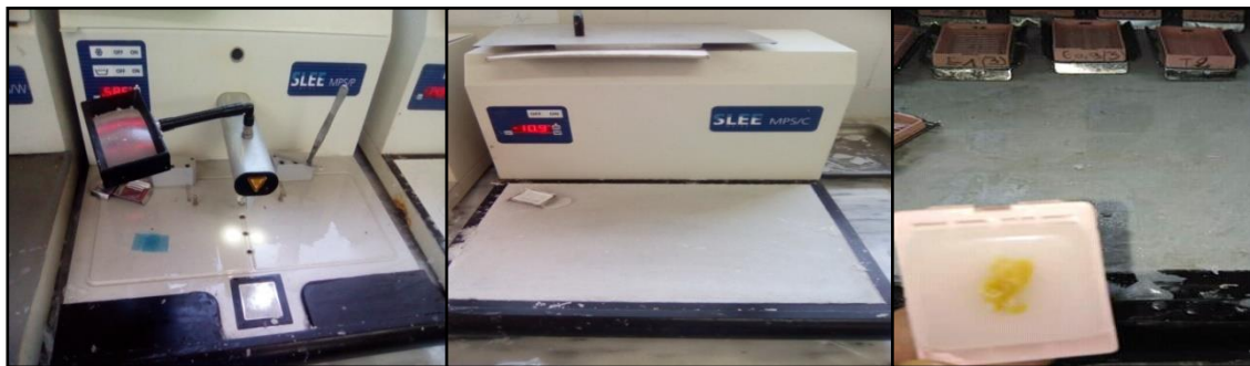
Figure 11 : Appareils d'enrobage (d'inclusion) du type SLEE (photo original).
