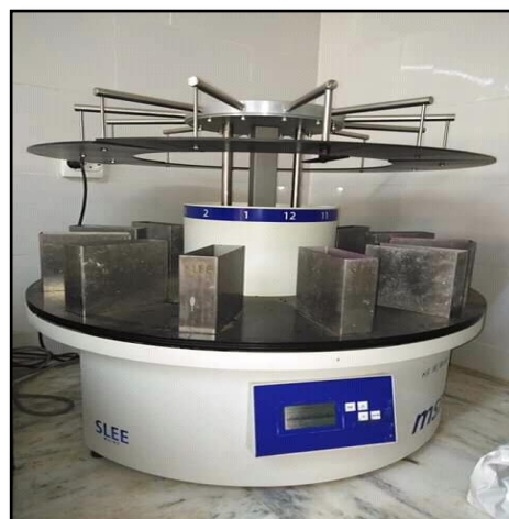
Figure 13 : Automate de coloration du type SLEE (photo originale).
